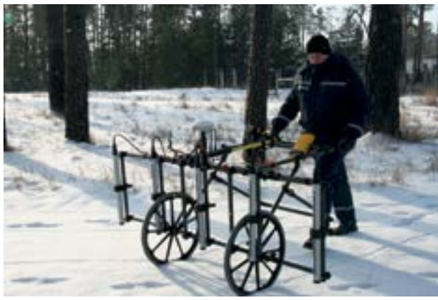
Сотрудник государственной службы по чрезвычайным ситуациям (ГСЧС) Украины проводит проверку многоканального детектора неразорвавшихся боеприпасов (НРБ), предоставленного в рамках проекта ФСОБ ОБСЕ, 12 декабря 2016 года, учебный центр ГСЧС, Харьковская область, Украина (ГСЧС)
