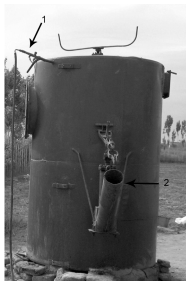
Фото 1. www.tugai.uz БГУ в собранном виде. Стрелками обозначены: 1. Отвод биогаза; 2. Механизм загрузки.
