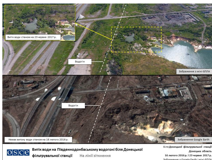
Рисунок 3. Отримані за допомогою БПЛА матеріали фотофіксації витіку води на Південнодонбаському водогоні в Донецькій області, червень 2017 р. (порівняно із зображенням тієї ж місцевості на мапах Google Earth станом на лютий 2016 р.)
